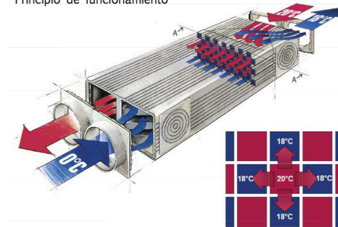
IMAGEN 1: Intercambiador de canales en contracorriente
