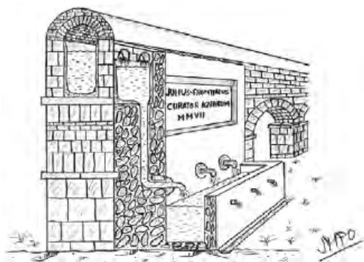
**Fig. 13** Esquema de una fuente aliviadero de un *Canalis Estructulis*
