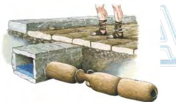
Fig. 15 Esquema de *Tubulis Fictilibus* para la salud<sup>18</sup>.
