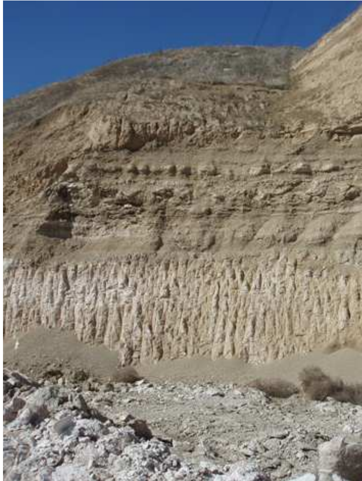
Detalle del frente de explotación, donde se observa la mineralización de sepiolita asociada a los niveles arcóscicos del tramo superior de la Cuenca de Madrid
