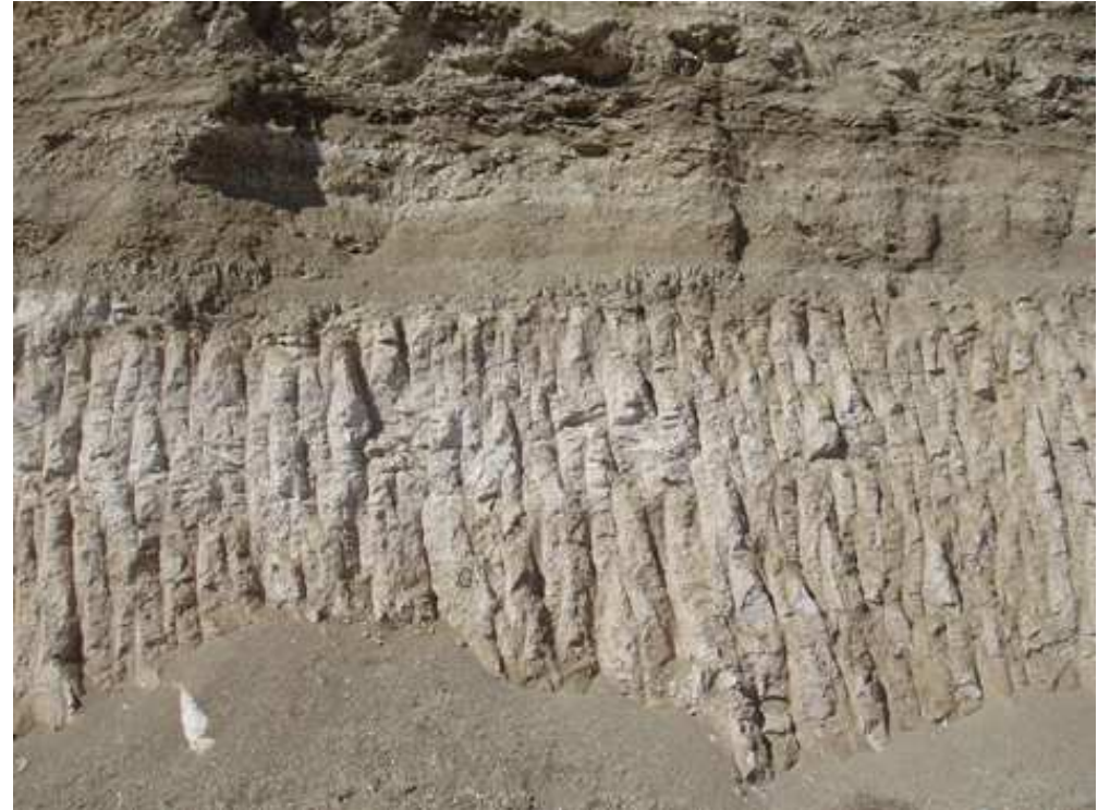
Detalle del frente de explotación, donde se observa la mineralización de sepiolita asociada a los niveles arcóscicos del tramo superior de la Cuenca de Madrid
