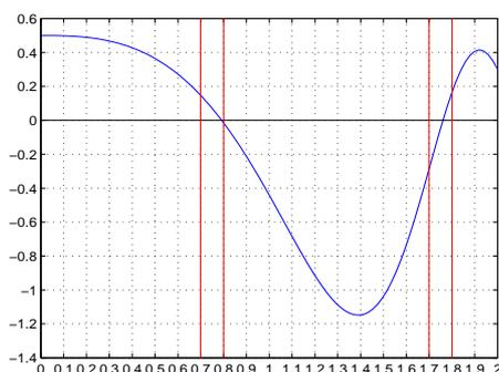
Como se puede apreciar en el dibujo, hay dos soluciones  $F(x) = 0$  una en el intervalo  $[0,7, 0,8]$  y la otra en el intervalo  $[1,7, 1,8]$ .
