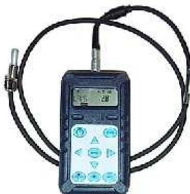
Un dosímetro es un tipo especial de sonómetro integrador diseñado como equipo portátil, para que pueda ser colocado en el bolsillo del trabajador cuya exposición al ruido deseamos medir.
